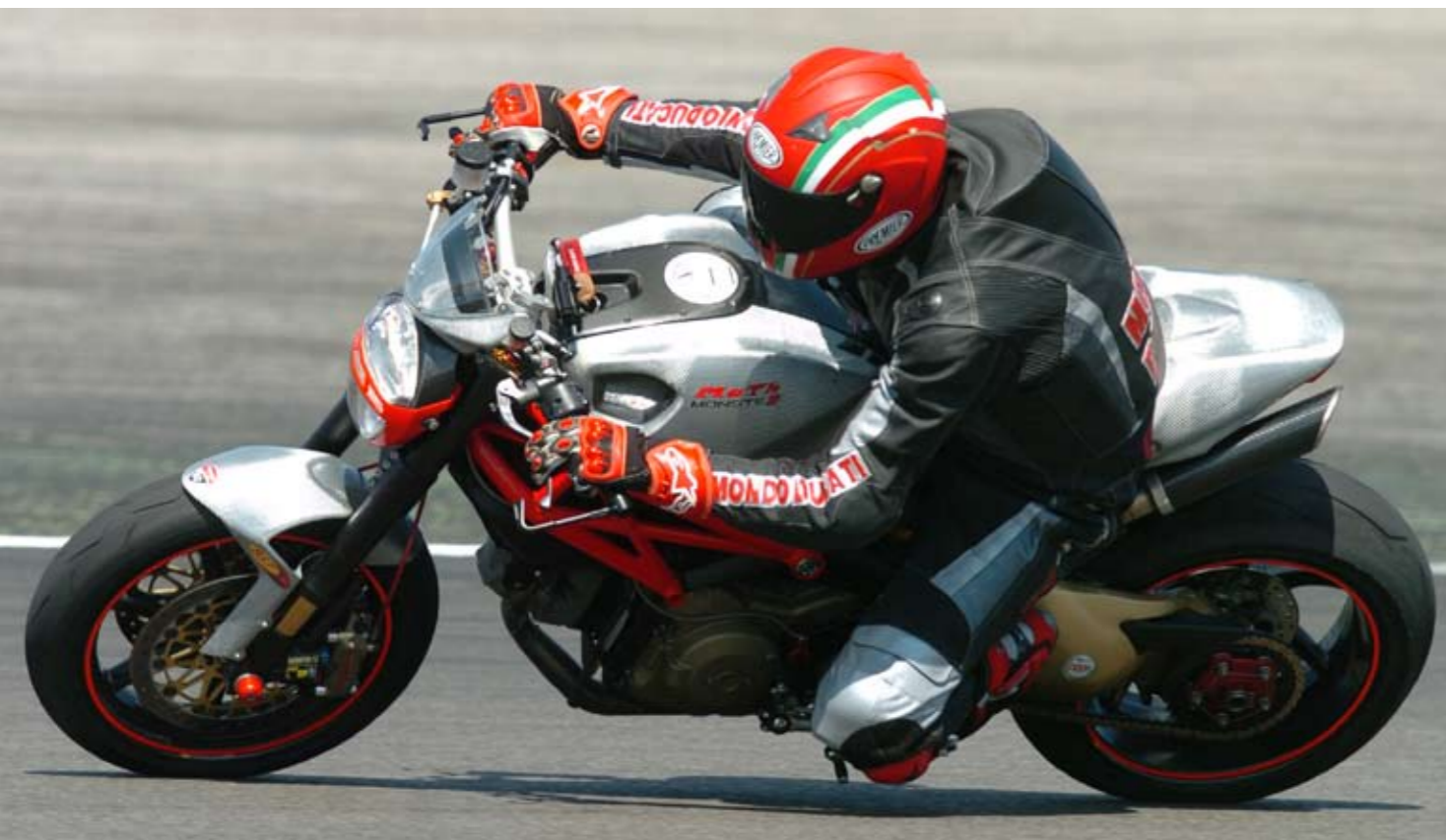
La coda corta esalta le forme della gomma posteriore, in grado di assicurare sempre la trazione necessaria in uscita di curva grazie alla maggior lunghezza del forcellone in magnesio Ram.
