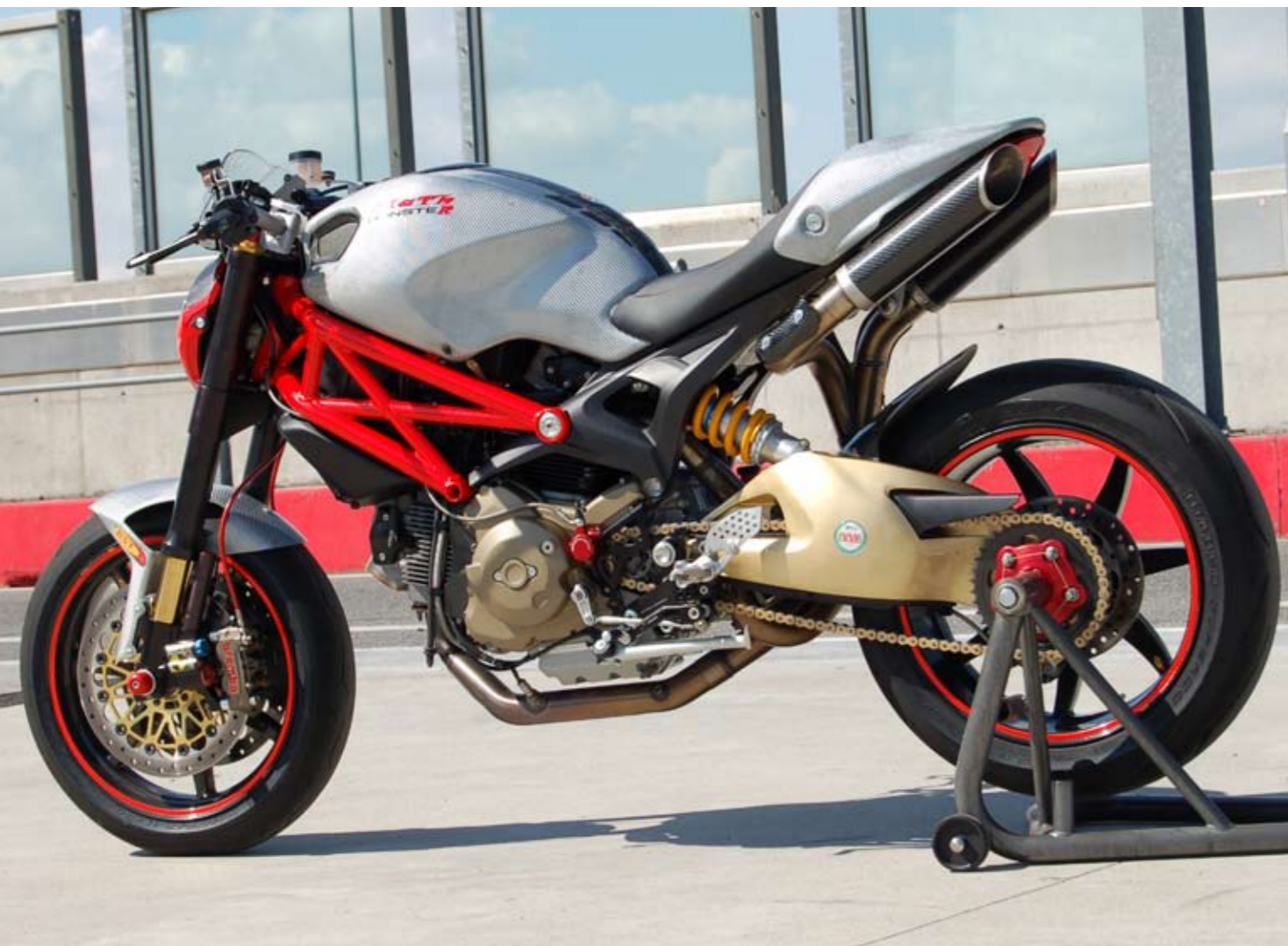
Impossibile non notare su questo Monster la presenza del forcellone monobraccio in magnesio prodotto dalla Ram, così come quella dell'impianto di scarico semiartigianale che termina sotto al codone con due piccoli silenziatori "slash cut".
