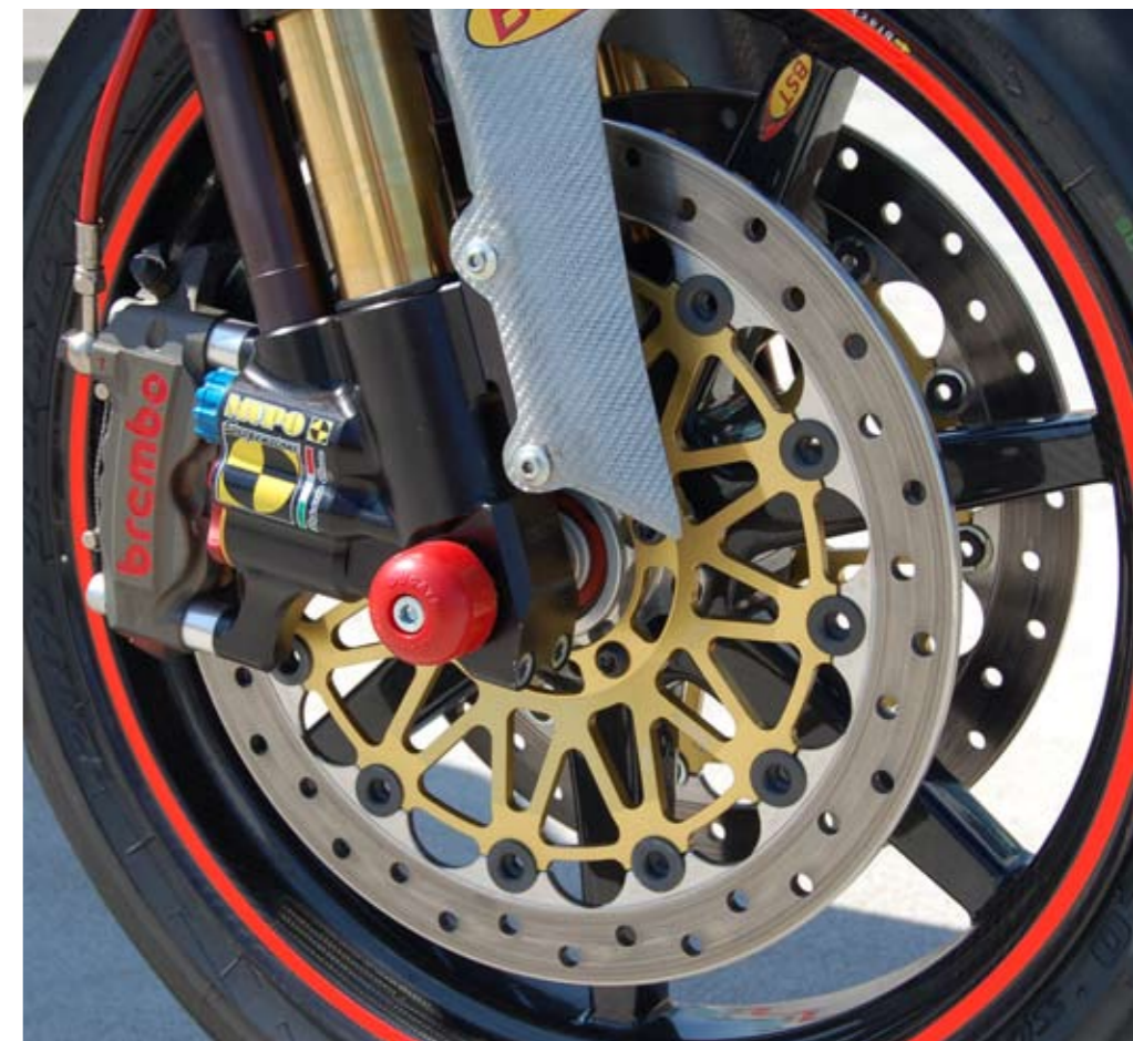
Sopra: l'impianto frenante Brembo racing, con dischi a pista bassa da 320 mm e pinze ricavate dal pieno ad attacco radiale, e la forcella Mupo pressurizzata. Sotto: il bellissimo forcellone in magnesio che non altera il cinematismo della sospensione posteriore, essendo perfettamente intercambiabile con l'originale.
